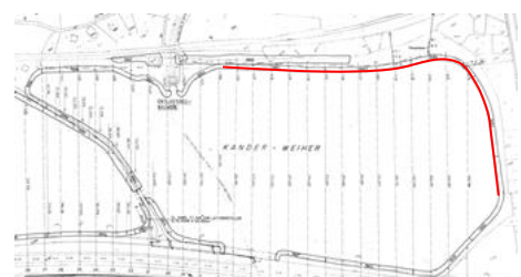
Speicherbecken mit Markierung des Bereichs der Dammaufschüttung
