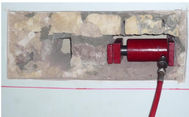
Abb. 9: Detailansicht des Festigkeitsversuchs in der Mauerwerkswand von Abb. 8.
