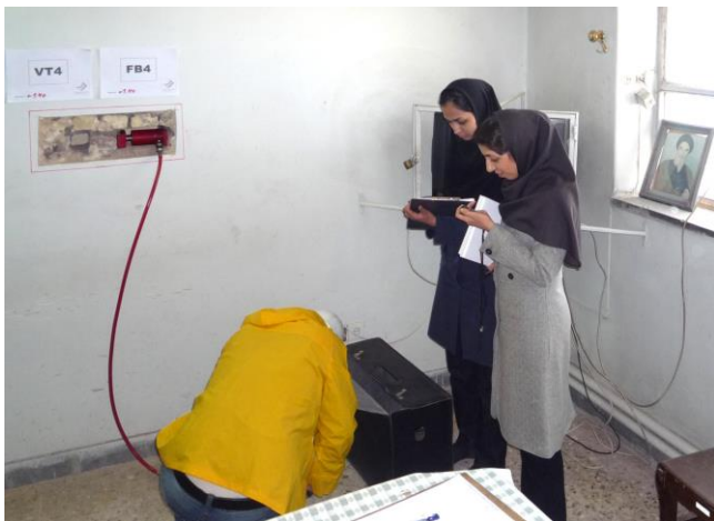
Abb. 8: Orthopädie-Abteilung des Bahonar-Spitals in Kerman: Festigkeitsversuch an Mauerwerkswand.
